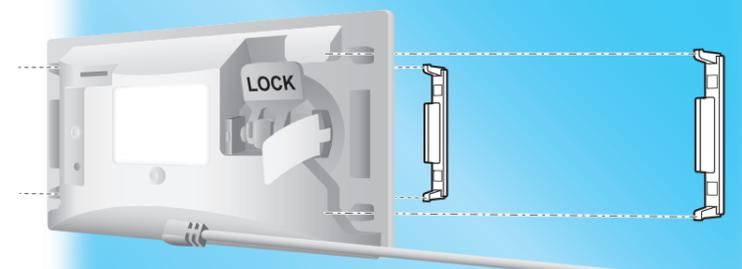
Al limpiar la ventana, si rocía excesivamente la ranura de montaje con agua o detergente puede afectar al adhesivo.
