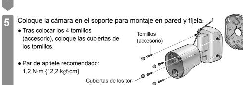
— Al apretar los tornillos – Es difícil apretar el tornillo cuando la cámara está orientada hacia delante. Utilice el método que se muestra en la ilustración de la derecha y apriete el tornillo tras rotar el cuerpo de la cámara hacia la izquierda o la
